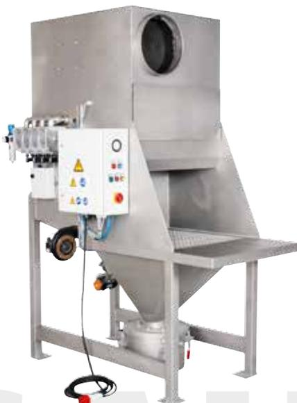
Der Aufgabetrichter mit Ablagetisch und Rückführungstrichter für abgeschiedene Stäube (beide individuell auf Kundenwünsche anpassbar) ist in einem Gestell integriert, auf dem die Wirbelstromabsaughaube und die Filteranlage platziert sind.
